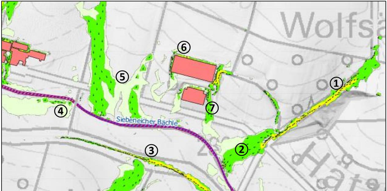
Abbildung 8: Die Fließgeschwindigkeit im Bestandsgelände „Siebeneicher Straße“ für das Szenario „selten“. Die Farbgebung stellt von grün über gelb nach rot die Fließgeschwindigkeiten „0,2 – 0,5 m/s“, „0,5 – 2 m/s“ sowie „> 2m/s“ dar.<sup>11</sup>
