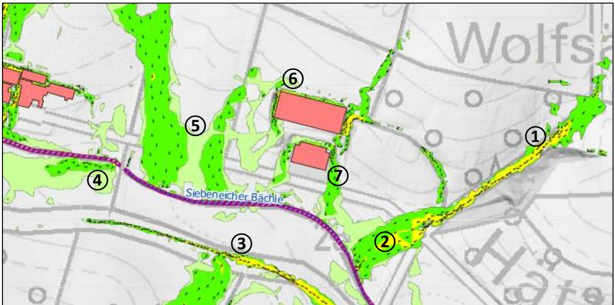
Abbildung 9: Die Fließgeschwindigkeit im Bestandsgelände „Siebeneicher Straße“ für das Szenario „außergewöhnlich“. Die Farbgebung stellt von grün über gelb nach rot die Fließgeschwindigkeiten „0,2 – 0,5 m/s“, „0,5 – 2 m/s“ sowie „> 2m/s“ dar.<sup>12</sup>
