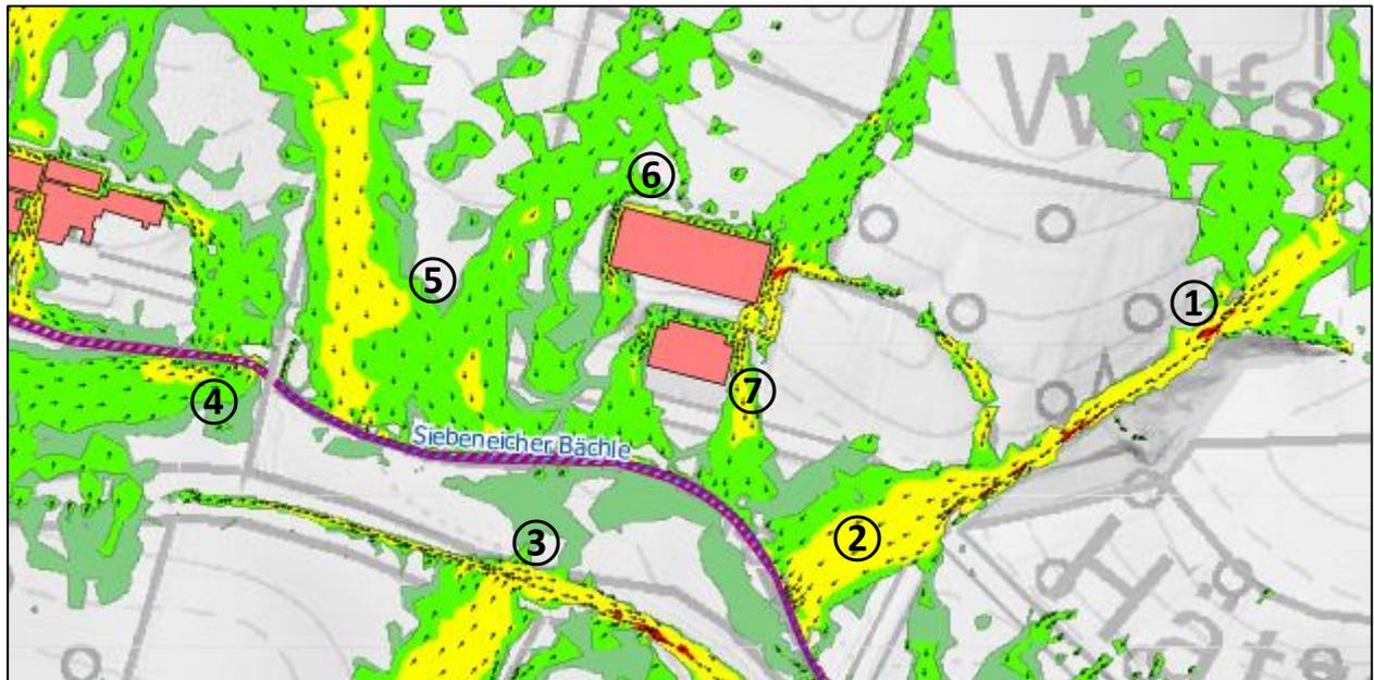
Abbildung 10: Die Fließgeschwindigkeit im Bestandsgelände „Siebeneicher Straße“ für das Szenario „extrem“. Die Farbgebung stellt von grün über gelb nach rot die Fließgeschwindigkeiten „0,2 – 0,5 m/s“, „0,5 – 2 m/s“ sowie „> 2m/s“ dar.<sup>13</sup>
